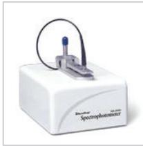
Cuvette이나 Capillary를 사용하는 기존 방식의 불편함을 해소시킨 새로운 개념의 UV/VIS Spectrophotometer입니다. Sample을 측정 표면 위에 직접 1~2 $\mu$ l만을 Pipping 하면, 표면장력에 의하여 2개의 Optical Fibers(광섬유)사이에 Measurement Column이 형성되어 쉽게 sample의 흡광도와 농도를 측정할 수 있음.
